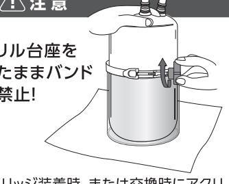
カートリッジ装着時、または交換時にアクリル台座に本体を置いた状態でハンドルを締め付けないでください。水漏れの原因となります。タオルなどの上に本体を置いてハンドルをしっかりと締め付けた後、アクリル台座に本体を載せてください。
