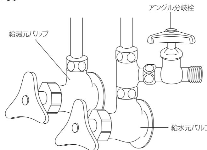
③ アングル分岐栓に逆流防止弁とワンダーチューブ(600mm)を取り付ける。
