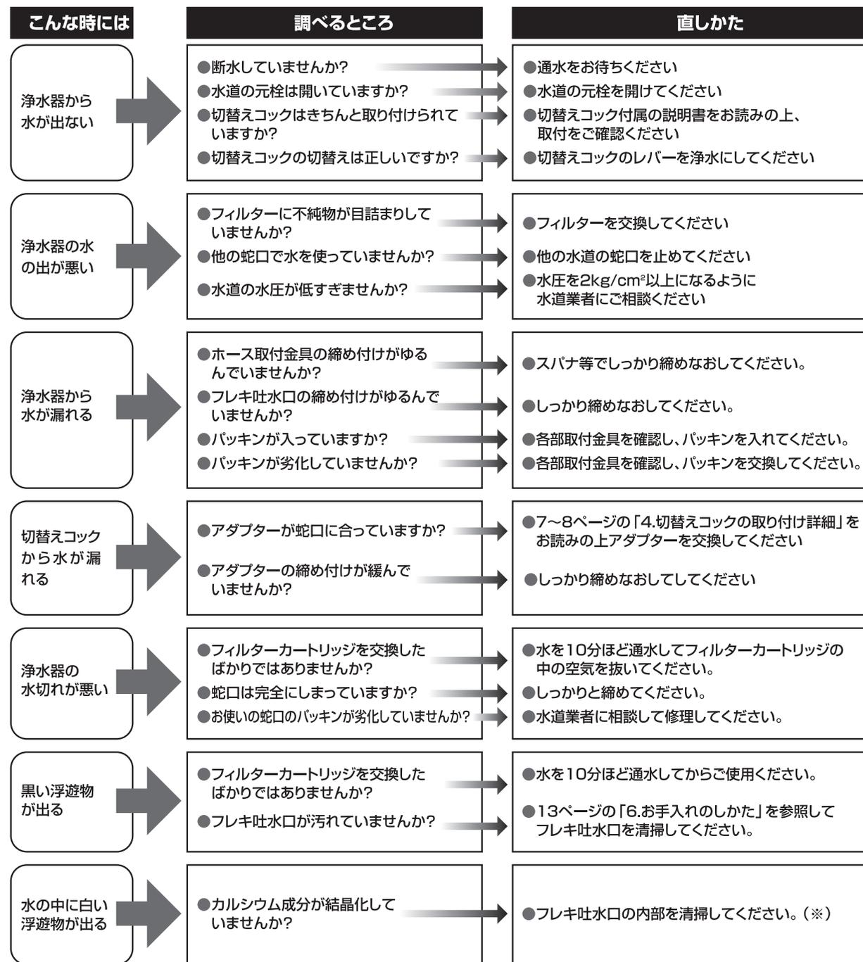
※水の中に白い浮遊物が出てくる場合がありますが、カルシウム成分が結晶化したもので、人体には害はございません。フレキ吐水口内側に結晶が付着している可能性がありますので、フレキ吐水口を取り外して、市販の塩素系洗剤に入れ、一晩つけおきしてきれいにしてください。取り付ける前には十分水洗いし、本体に装着後、水を10分以上通水させてからご使用ください。
