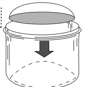
■ フィルターカートリッジの交換時に取り出して水洗いをし、再び装着してください。
